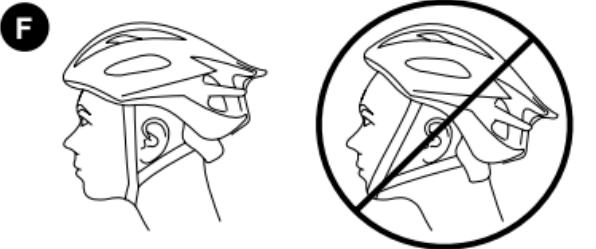
Póngase el casco y abroche las hebillas para comprobar que las correas están bien tensas. Cuando abra la boca, debe notar que la correa tira bajo la barbilla. Intente quitarse el casco tirando adelante y atrás de él. Si consigue quitarlo, debe tensar más las correas. El casco no debe moverse demasiado. No debería existir la posibilidad de quitarse el casco sin desabrochar las hebillas.
